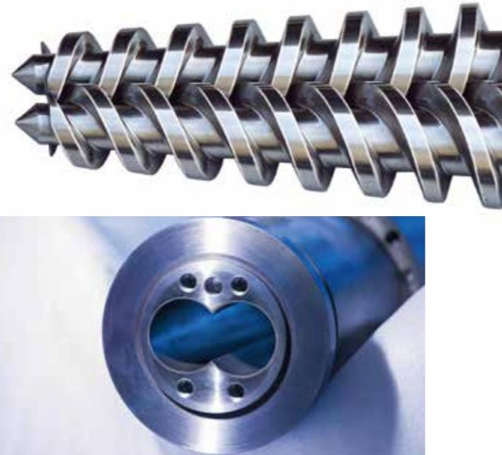
机筒合金工艺一种是采用离心浇铸成型管状或空心筒状制品的一种方法，浇铸合金材料有镍基、铁基合金两种；镍基合金耐腐蚀、铁基合金硬度高更耐磨。另外一种是采用内孔镶SKD合金套，提高耐磨度。
