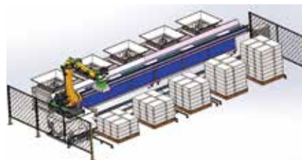
机器人破包上料系统 Robot breaking and feeding system
