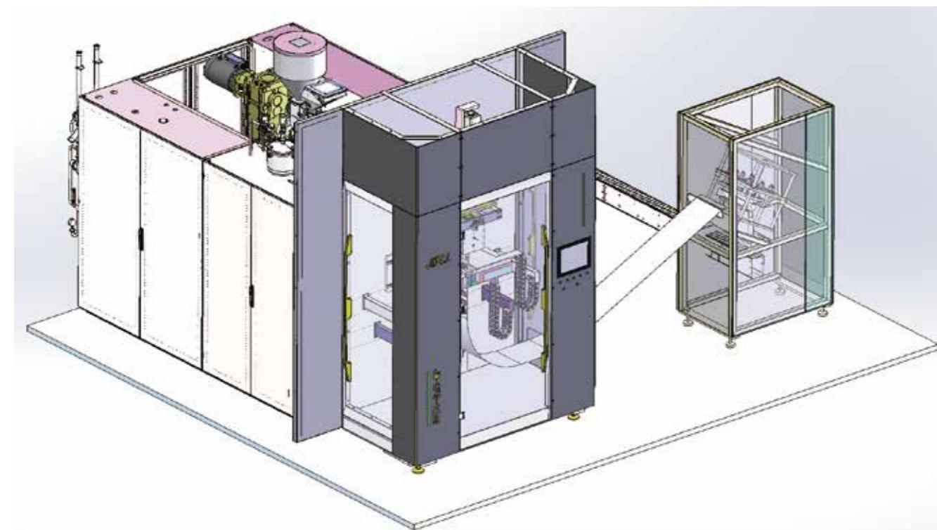
**小容量产品:** 主要用于小容量注射剂、滴眼液、滴耳液、气雾剂、吸入剂、麻醉剂、化妆品及食品产品，装量范围0.1ml–20ml，产量取决于灌装量及模具腔数。
